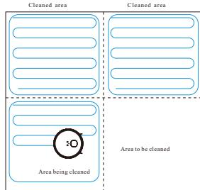
2. Auf der Grundlage der Teilung der vorhandenen Karte werden die eingeschlossenen Bereiche zunächst durch die Reinigung der Kanten gebildet und dann in Z-Form aufgefüllt. Füllen Sie dann die übrigen Bereiche nacheinander aus.
