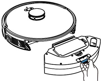
2. Halten Sie die Taste für Staubbox gedrückt, um die Staubbox zu öffnen und den Abfall zu entleeren.
