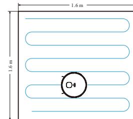
3. Der Saugroboter fährt an den vorgesehenen Ort und säubert eine quadratische Fläche von 1,6 m x 1,6 m mit sich selbst in der Mitte, säubert die Fläche zwei Mal hintereinander und kehrt danach zum Aufladen zurück.
