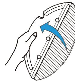
4. Befestigen Sie den Wischtuchhalter an der Unterseite von 2-in-1 Staubbox & Wassertank
