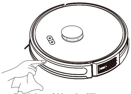
Es wird empfohlen, den Klippensensor einmal im Monat zu reinigen.
