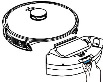
2. Pulse y mantenga el interruptor del depósito de polvo para abrirlo y verter las basuras.
