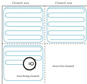
2. Selon les zones de la carte, le robot commence par le nettoyage par bord pour former une zone fermée, puis nettoie la zone fermée en zigzag. Ensuite, il nettoie les zones rest une par une.
