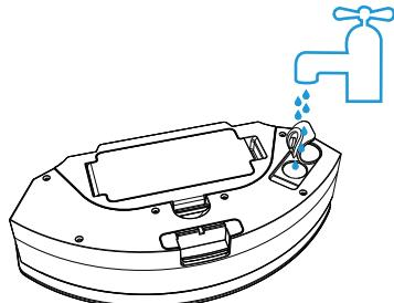
2. Instalar la caja de polvo & agua 2 en 1 en la el robot aspirador.
