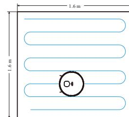
3. Il robot aspirapolvere si sposta nella posizione specificata e pulisce una zona di 1,6m x 1,6m centrata su se stesso. Dopo aver completato due pulizie di questa zona, il robot aspirapolvere torna alla stazione di ricarica per ricaricarsi.
