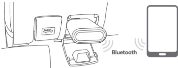
Abra la aplicación Dollarfix y buscará automáticamente los dispositivos activados. Seleccione su dispositivo y conéctese a él a través de Bluetooth dentro de la aplicación.
