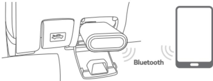
Ouvrez l'application Dollarfix et elle recherchera automatiquement les appareils activés. Sélectionnez votre appareil et connectez-vous-y via Bluetooth dans l'application.
